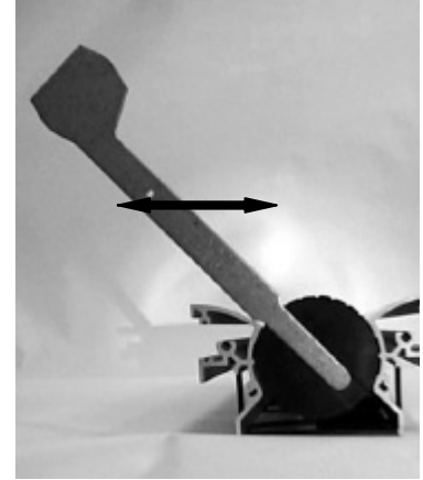
Walzenstellung schließen: Das andere Ende des Verstellschlüssels wie gezeigt ansetzen.
