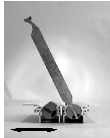
Walzenstellung schließen: Das andere Ende des Verstellschlüssels wie gezeigt ansetzen.
