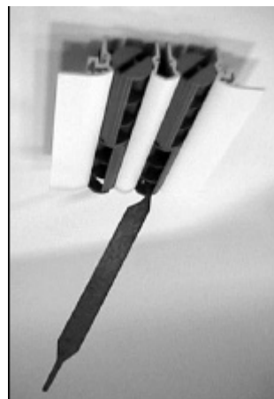
Walzenstellung 0, 1, 2 oder 3 ein- stellen: Verstellschlüssel wie ge- zeigt ansetzen.
